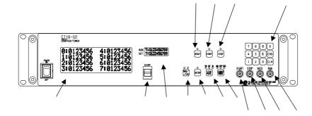
LCD表示器 20文字×4行 測定データ、SET UP画面の表示を行います。
