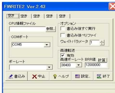
2. 高速転送にチェックを入れ、クロック(Hz)に、12000000と書き込みます。(ボーレートが19200(8~18MHz)、高速ボーレートが38400になっていますがこれは変更しません)
