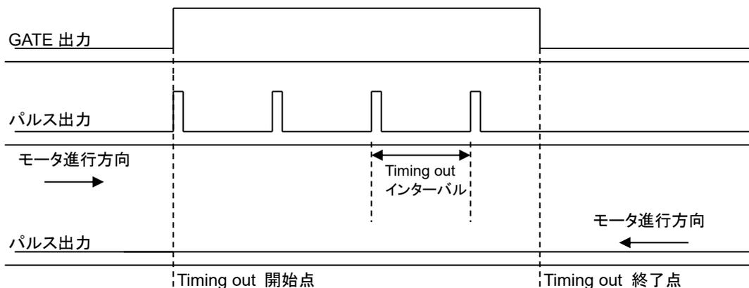
モータの進行方向が開始点から終了点へ向かっている時に、START を通過すると設定したパルス幅(200ns ~ 1ms)のパルスを出力し、その地点より STOP を通過するまでインターバルの値だけ進む度にパルスを出力します。
