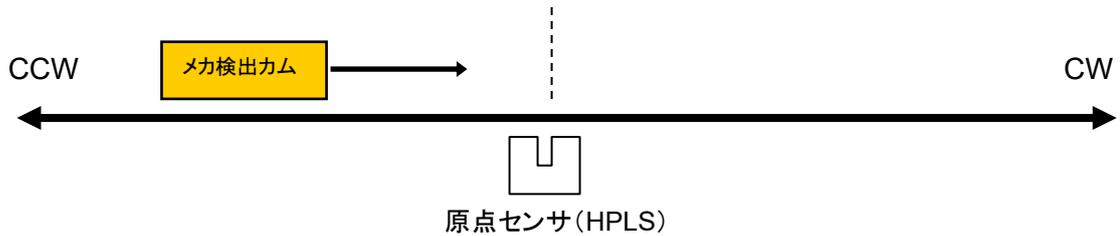
原点センサを検出するとモータは自動停止し、その時の検出方向と原点の位置を記憶します。ただし、検出する際の移動速度が速すぎてセンサの応答時間範囲外にならないように注意してください。移動前には、速度の確認を行ってください。
