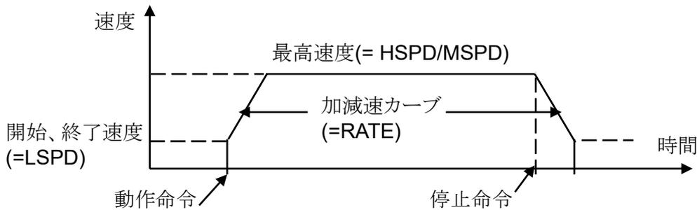
動作命令を実行すると **LSPD** を初速として **MSPD**、もしくは **HSPD** に達するまで加速し動作します。停止コマンドを入力すると減速を開始し、**LSPD** に達した時に停止します。加減速コード(47 ページ参照)で示される **RATE** 値が大きい程、加減速カーブの傾きが急になり最高速に達するまでの時間が短くなります。初速、終了時の速度が **LSPD** でありますので、**LSPD** の値が大きいと脱調等によりモータが駆動出来ない場合があります。
