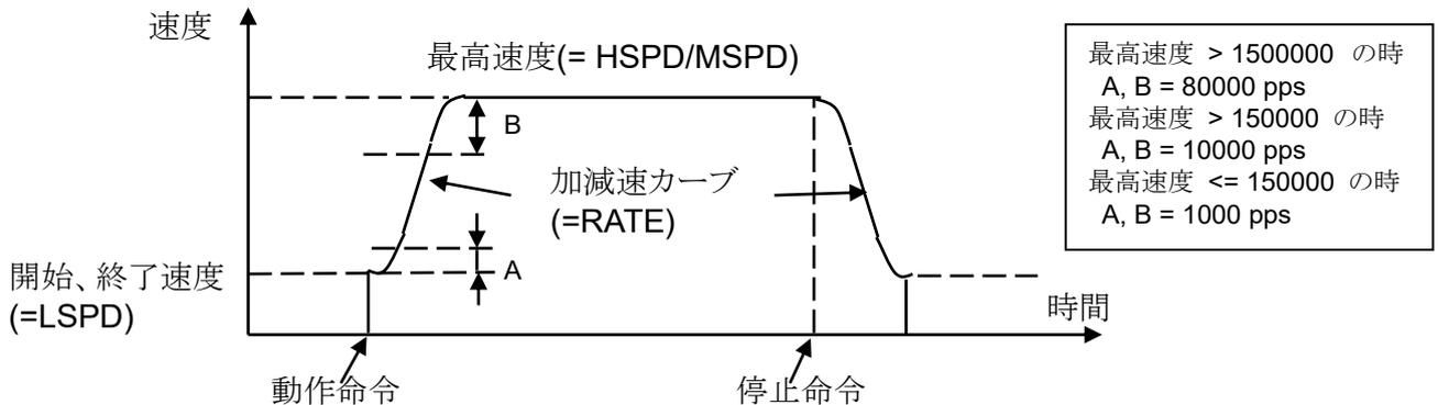
基本的には台形加減速運転と同じですが、加減速開始時、終了時の速度変化が放物線に近似した **S** 字加減速カーブに従って行われます。
