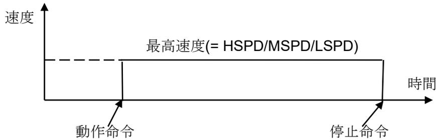
動作命令を実行した瞬間より、設定した速度で動作し、停止命令を実行した瞬間に即時停止します。速度が速い場合、モータの脱調が起こり得ますので十分ご注意ください。
