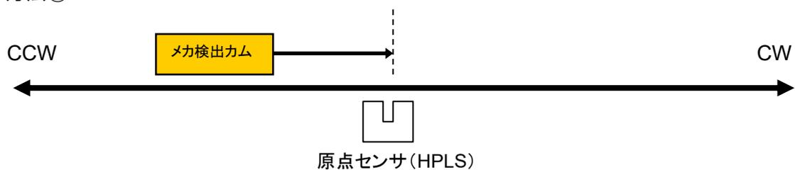
原点センサに向かって連続移動を行い、原点センサを検出したら急停止して検出を完了します。
