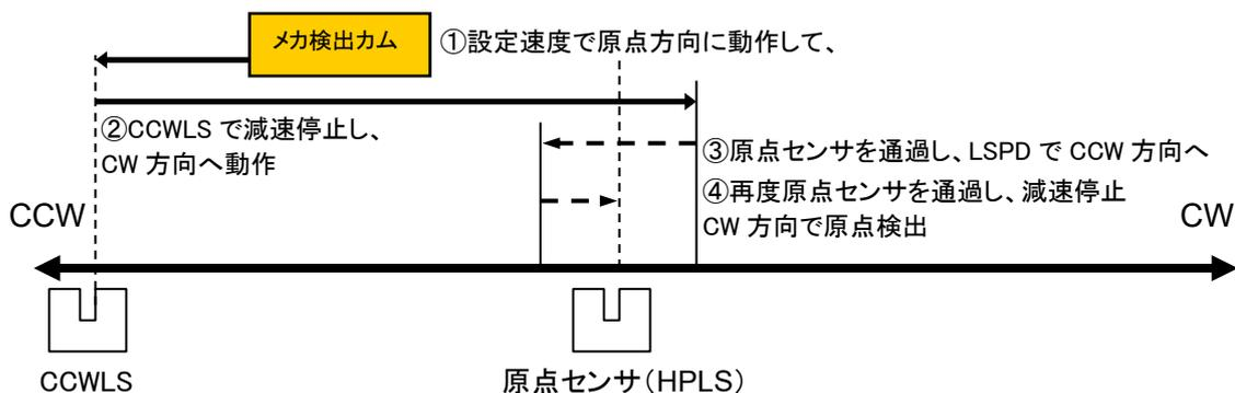
原点センサを検出したら最初は通過し、完全に通過したら停止し **LSPD** で原点に向かいます。原点検出開始方向とは反対の方向から原点センサを検出したら急停止し、原点位置情報が記録され、センサに近づいた方向も記録されます。原点センサを検出しないまま **STOP** ボタン、停止コマンドで停止した場合は、原点検出なしで停止します。
