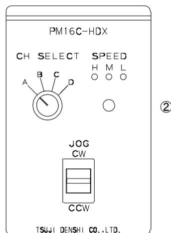
● HDX02 ハンドボックス(PM16-HDX2 2 軸同時コントロール)
