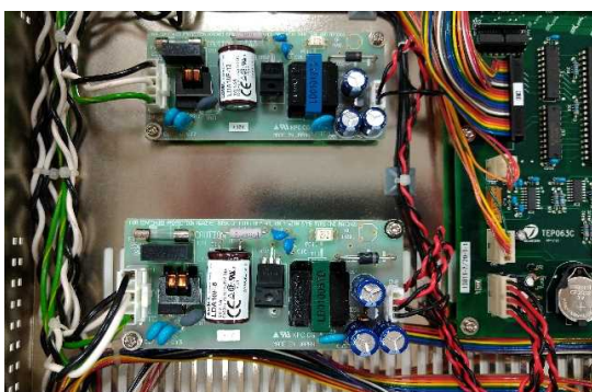
[写真13]電源交換後参考図
